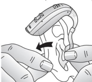
*Meta el molde detrás del pliegue de la piel por encima del canal auditivo.*
