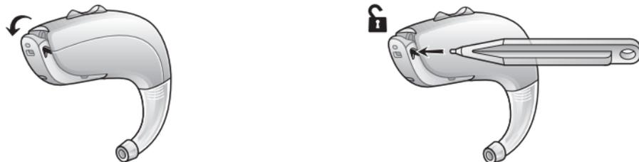
*Abra el portapilas a la posición de "apagado". Desde el lado derecho, mueva el control deslizante hacia la izquierda.*
