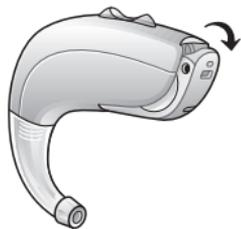
*Abra el portapilas a la posición de "apagado".*
