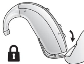
*Abra el portapilas completamente para sustituir la pila.*
